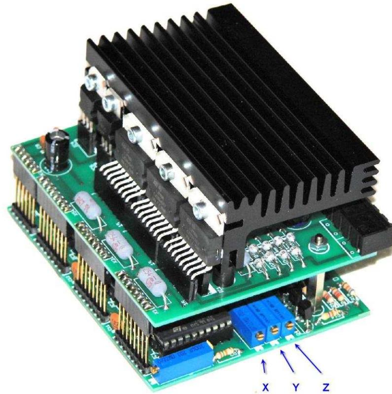
Hier lässt sich der Motorstrom einstellen, die Motoren sollten alle Handwarm werden im Betrieb.
