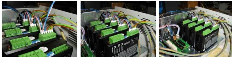
Die Verbindungskabel zu den Sub-D Buchsen werden in der gleichen Reihenfolge an den Endstufen angeschlossen wie sie an den Sub-D Buchsen verlötet und in der Blende eingebaut sind.
