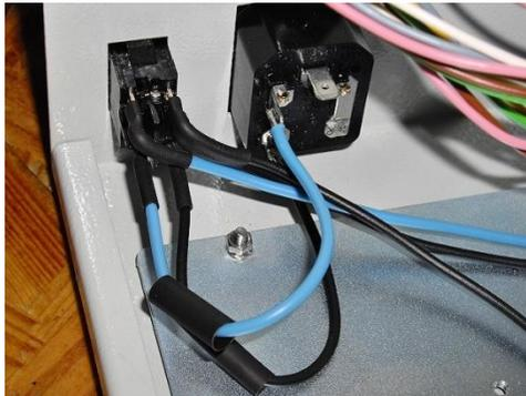
9. Einbau Netzteil ( bei der 48V Version ist das Netzteil als allererstes einzubauen, Verschraubungen von unten)
