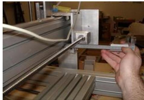
Schrauben aber erst nach der Montage der X-Achse festziehen.
