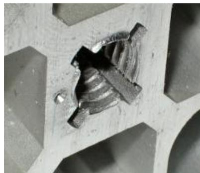
Die Schraube nicht komplett eindrehen, zwischen Kopf und Gleitstein ca. 1mm Luft lassen. Der Gleitstein "klappert" jetzt mit etwas Spiel.
