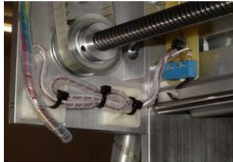
Endschalter Y Mit Gleitmutter M4 und Schraube M4 x16 montieren
