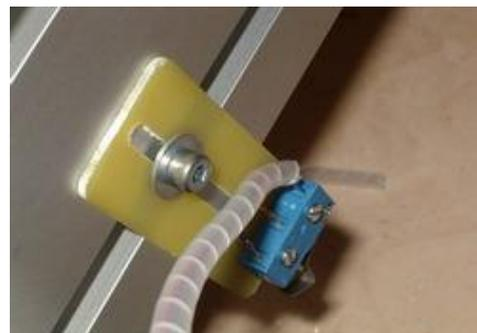
Seitlich an den unteren Wagen X eine Schraube 4 x16 mit Mutter als Anschlag einbauen.
