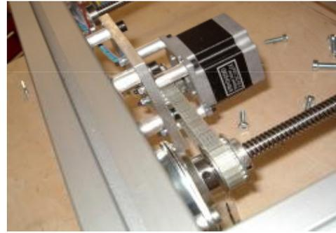
Die Motorplatte mit Motor auf das Stirnseitenprofil montieren.
