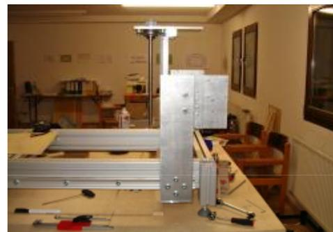
Das Flanschlager wird von außen mit M6 x22 und 2 Distanzröllchen
