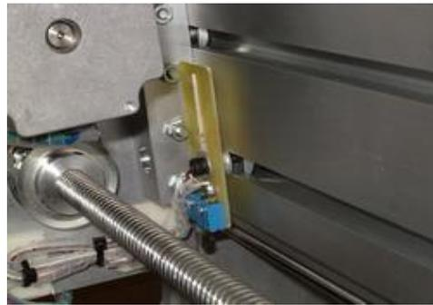
Endschalter mit M4 x20 mit großer U-Scheibe und einem Gleitstein M4 montieren
