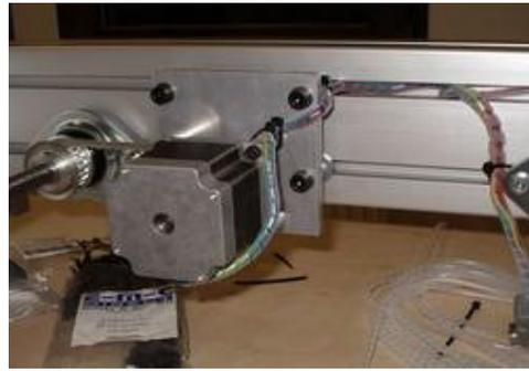
Zugentlastung des Kabels X und Z
