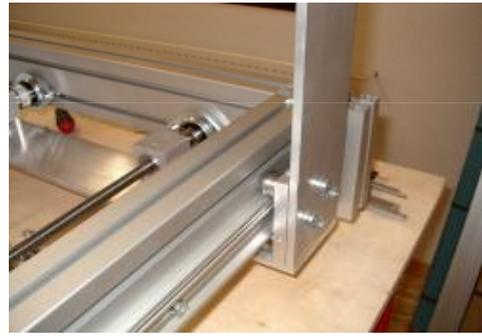
Sollten die Laufschienen noch Kleberreste aufweisen können diese mit Reinigungsöl entfernt werden.
