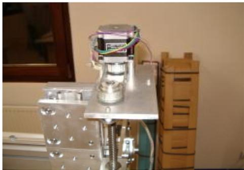
Die Motorplatte wird mit dem Halteklötz befestigt
