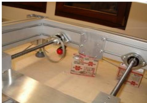
Vor der Montage der 2ten Lagerseite bitte daran denken die Gewindespindeln/Gewindemuttern/Gewindemutternhalter Zahnriemen und Riemenräder vorzubreiten und zwischen die Lager zu montieren.
