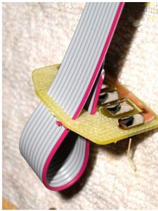
Mit dem Kabel eine Schlaufe bilden und von unten durch die Platine ziehen zur Zugentlastung des Kabels.
