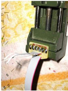
Die Stiftleiste in einen Schraubstock zum Löten einspannen, mit dem 5ten Kabel wird mit dem Löten begonnen. Gezählt wird ab der roten Markierung
