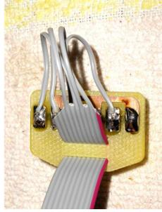
Fertig, Kabelenden zurechtbiegen und anderes Kabelende über die gelöteten Pads legen.
