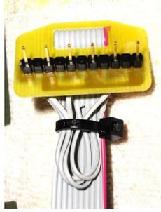
Mit einem Kabelbinder die Einzeladern sichern.
